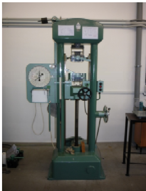
Trhací stroj ZDM 5 ( F_{\max} = 50 \text{ kN} )
