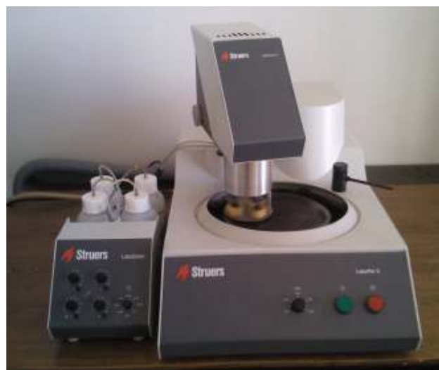
Prístroj na brúsenie a leštenie vzoriek LaboPol-5 s automatickým dávkovačom suspenzií LaboDoser a unášačom pre tri vzorky LaboForce-3
