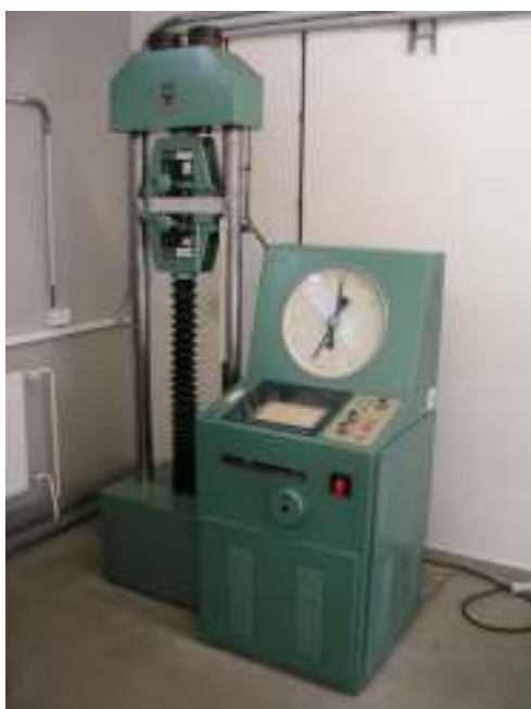
Trhací stroj ZD 10/90 ( F_{\max} = 100 \text{ kN} )
